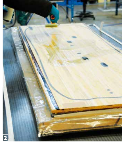
1 | Qualität und Stabilität auf höchstem Niveau: Die Edelstahl-Inserts werden bei der Carbon Pro Line vor dem Laminiervorgang von Hand eingesetzt und mit einem speziellen Kleber fixiert. 2 | Harzauftrag auf dem Holzkern: Gut erkennbar, wie das Harz eine glänzende Oberfläche bildet und mit der Harzrolle in die Fasern einmassiert werden muss. 3 | Honeycomb-Waben trumpfen als Baustoff für Kiteboards mit einem hervorragenden Raumgewicht und besten Festigkeitswerten auf. Durch das Risiko von Delaminationen sind sie für extrem leichte Kiteboards aber nicht optimal geeignet.
